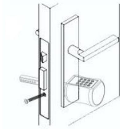
Установите ручку, затяните винты. Проверьте работу при помощи задней ручки.
