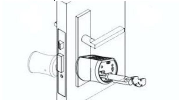
При аварийной ситуации снимите пластину, вставьте механический ключ и проверните на 30 градусов. Откройте дверь при помощи ручки.
